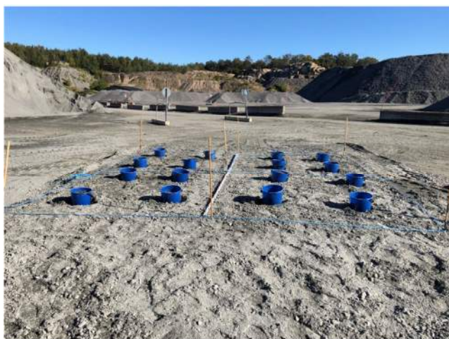
Figur 2. Exempel på uppdelning av provtagningsytan i kvadranter till vänster. Till höger visas en skiss på var proverna togs ut och provnumrering (provtagningsytan sedd från ovan). Ett prov representerar materialet i en fyrkant. Numreringen av proverna varierade beroende på provtagningsyta.
