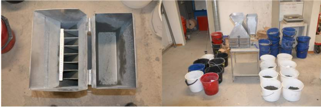
Figur 33. Foton på använd neddelningsutrustning och resultat av neddelningen i form av de fyra laborieproverna.
