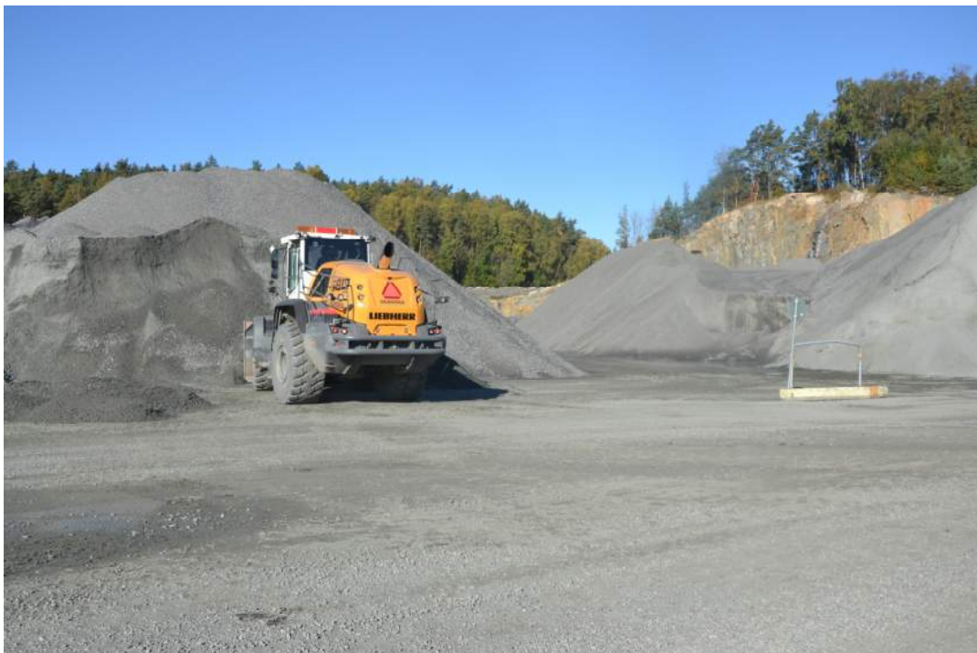
Figur 28. Lastmaskinist tar material i upplagshög före det att lastbilen lastas.
